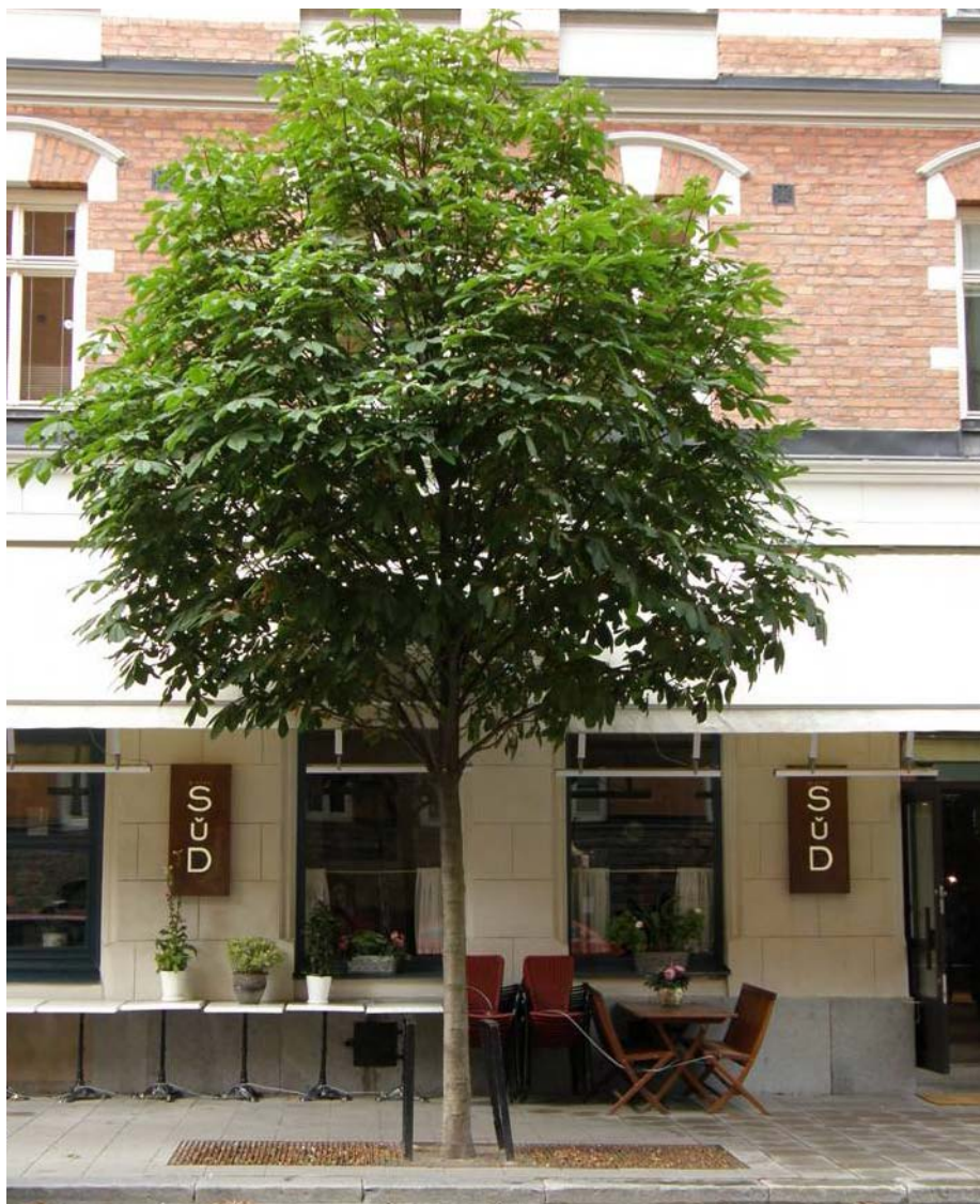
Nya gatuträd på Swedenborgsgatan i Stockholm. Äldre träd har bytts ut mot nya. 15 m 3 skelettjord/träd och luftigt bärlager har lagts under den hårdgjorda beläggningen. (Foto: Björn Embrén)
