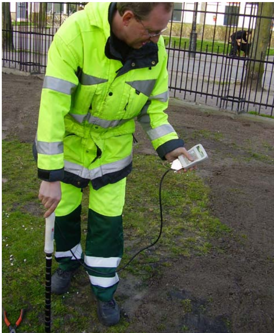
Bevatning är en central del av etableringsprocessen för träd. Här mäts fuktigheten i mark med elektronisk utrustning vid nyplanterade träd i vegetationsyta. (Foto: Örjan Stål)
