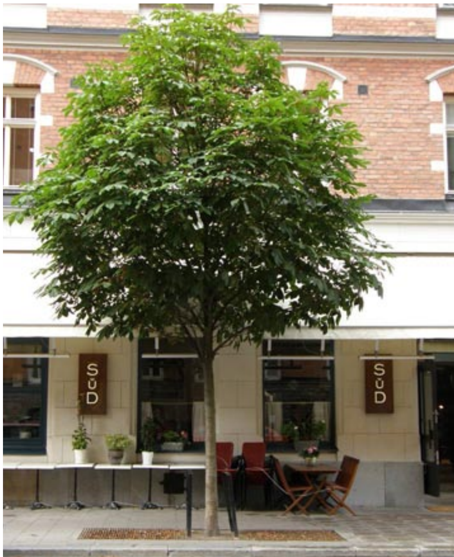
Nya gatuträd i Stockholm. Äldre träd har byts ut mot nya. 15 m 3 skelettjord/ träd + luftigt bärlager är lagd under den hårdgjorda beläggningen.
