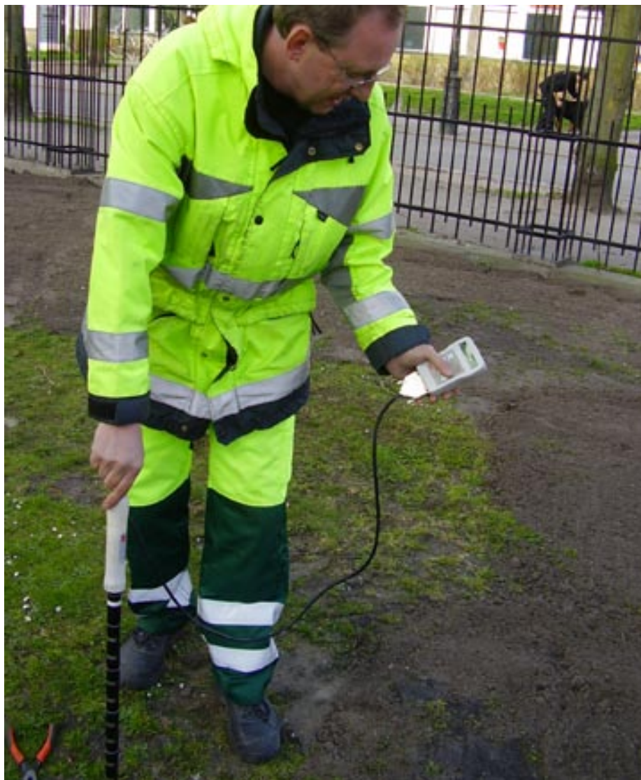
Bevattning är en central del av etableringsprocessen för träd. Här mäts fuktigheten i mark med elektronisk utrustning vid nyplanterade träd i vegetationsyta.
