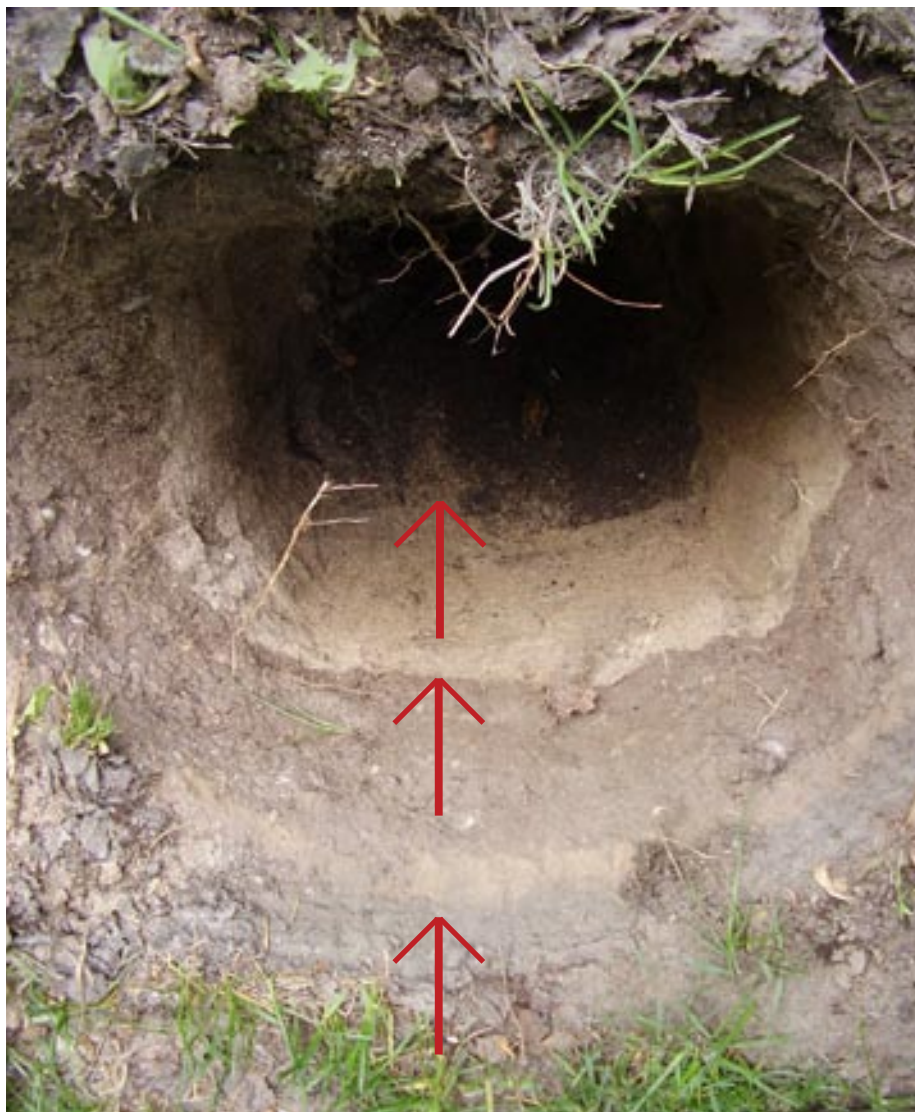
Ett exempel på störd markprofil där tre helt olika jordtyper har lagts ut i lager ovanpå varandra. Detta får bl a till konsekvens att den kapillära vattentransporten i jordprofilen försvåras avsevärt.
