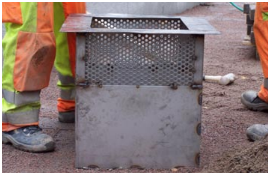
Luftbrunn typ TVL 2333 Clarova. Brunnen placeras direkt ovanpå skelettjorden. Brunnen för ned dagvat- ten i skelettjorden och sörjer samtidigt för lufttillgång vilket möjliggör det för träden livsviktiga gasutbytet i marklagren.
