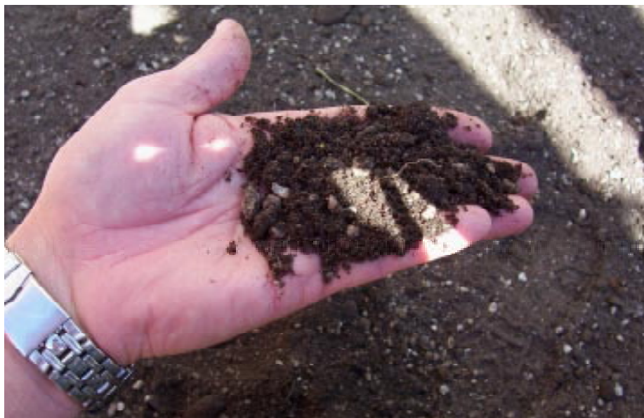
Växtjord typ C med lava- och pimpstensfraktionerna synliga som grövre korn i jorden.
