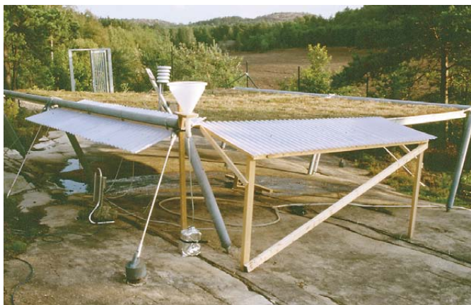
Experimentyta i Litsleby, Tanum, där man testat effekterna av skyddstak över en ristningsfri hällyta i bohusgranit. Foto: Runo Löfvendahl.
