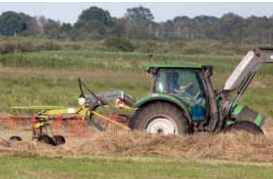
En rotorsträngläggare placerar det torkade höet snabbt och effektivt i strängar.
