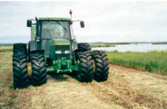
En traktor med dubbelmontage minskar risken för körskador i blöta sidvallsängar eftersom marktrycket fördelas över en större yta.
