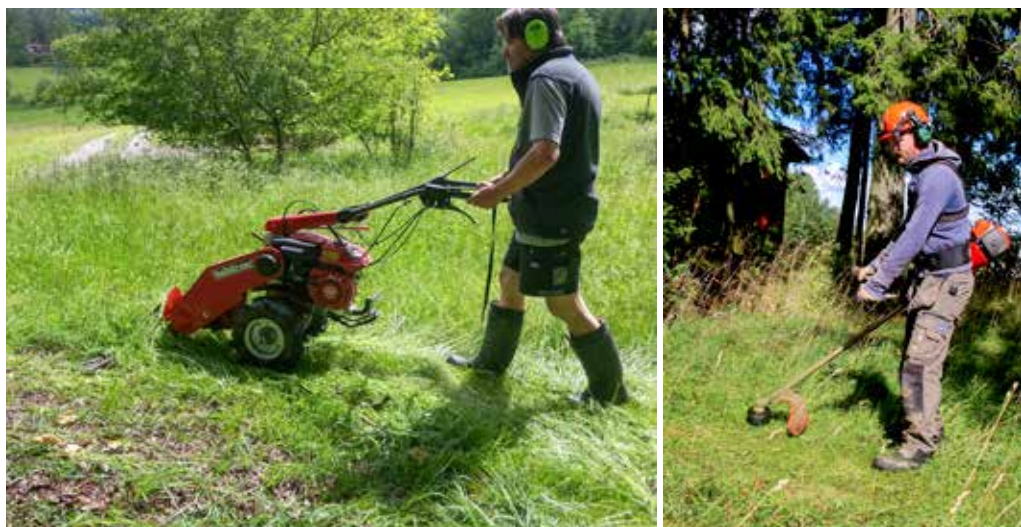
FIGUR 1. Användandet av mekaniska slätterredskap har ökat allt mer medan användandet av lie minskar. Slätterbalken skär vegetationen med en klinga och efterliknar därför lieslätter på ett bra sätt. Gräsrojären slår av gräset och örterna med hjälp av en roterande plastlina och har länge ansetts ha en negativ effekt på växtligheten.
