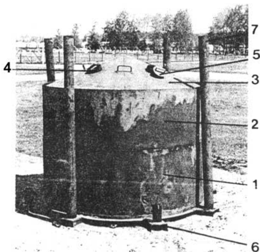
Fig. 17. The T.P.I. Steel Kiln
