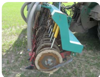
Myllning med skivbillar. Foto: Lena Engström
