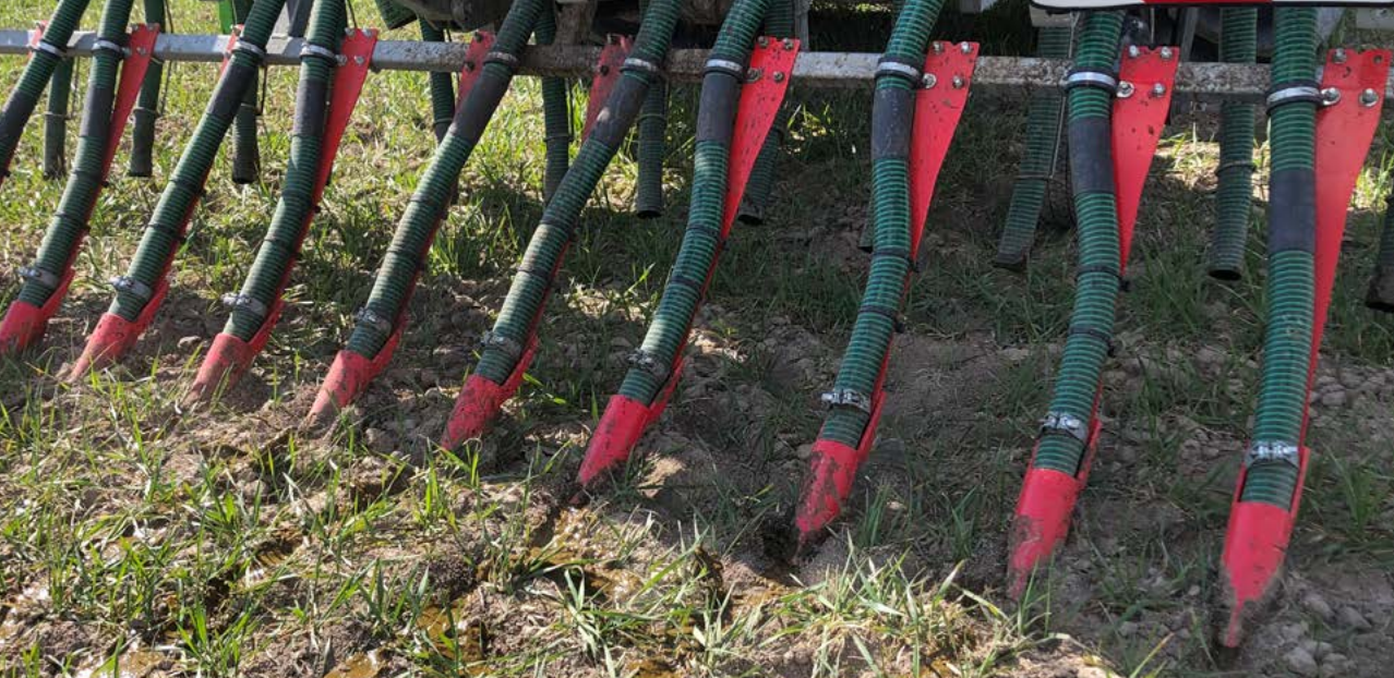
Gödselspridning med släpotsramp. Foto: Sofia Delin
