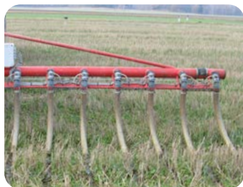
Spridning av flytgödsel med släp- slangramp. Foto: Sofia Delin
